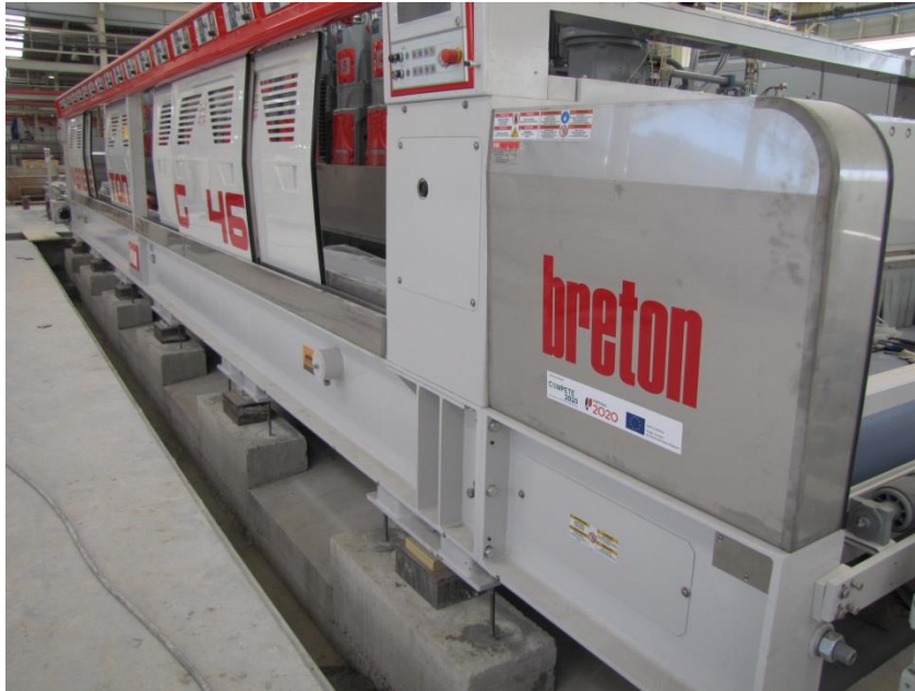
Fotografia nº 9 - Polidora de chapa de 17 cabeças Breton com selecção de chapa e carregadores
